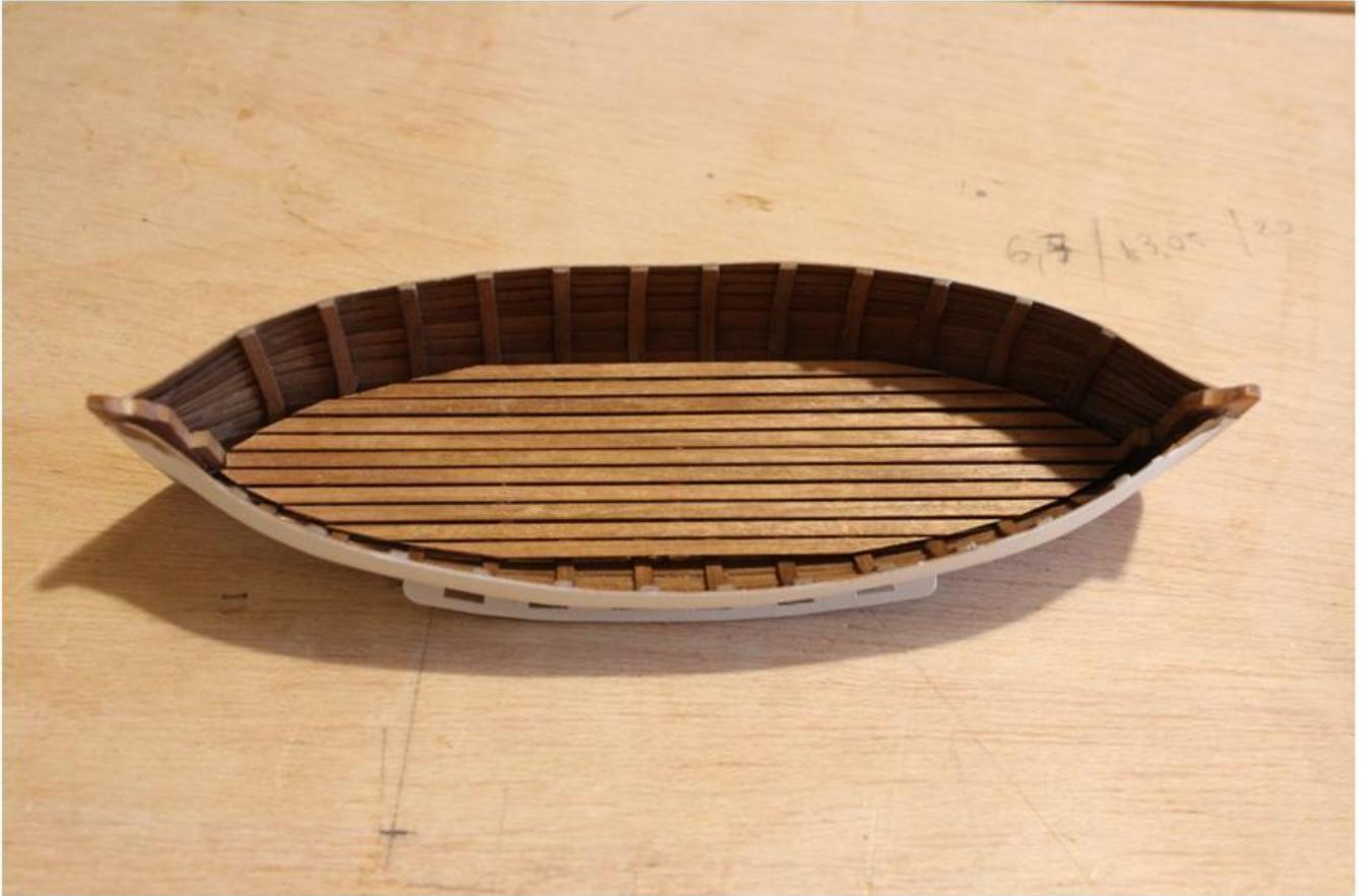
Con listón de cerezo de 2mm de espesor elaboro la estructura superior del interior del bote y de los asientos. La pieza hay que diseñarla bien, lijando y ajustando hasta que encaje perfectamente. Por supuesto hay que practicar los rebajes en el borde para que asiente bien sobre las cuadernas.
