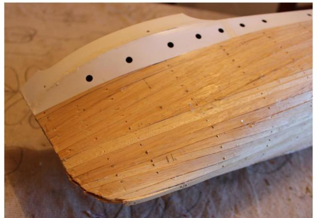
Una vez terminado el forrado levanto la cubierta y doy bien de cola blanca a todo el interior, a fin de conseguir una mayor consistencia de la estructura. Vuelvo a clavar la cubierta y dejo secar varias horas. Posteriormente retiro los clavos del entramado.
