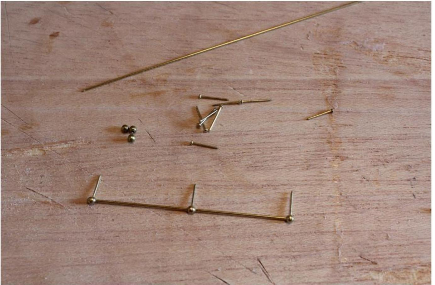
Las puertas las fabrico cortando trozos de cerezo a los que añado unas tiras finas de manzonia. Los picaportes los elaboro a partir de alambre de latón de 8 mm a los que doy forma con ayuda del tornillo de mesa.
