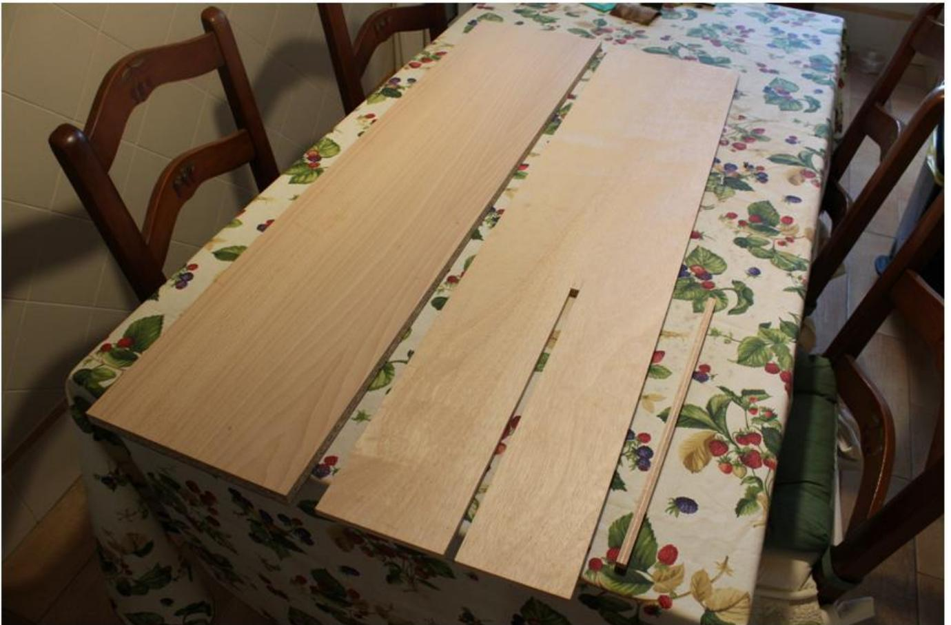
Como se observa en la foto anterior, al tablero más fino le he practicado una hendidura para alojar el cable de salida. El trozo que he cortado lo rebajo a la mitad de su espesor con la sierra circular y posteriormente lo pegaré a la base para tapar el hueco.
