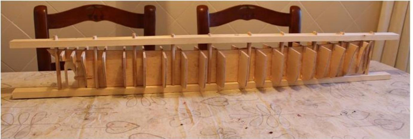
Una vez ha secado bien la cola, desmonto el entramado y clavo la estructura en uno de los listones de pino para que no pierda la forma. A partir de una plancha de contrachapado de abedul de 1mm de espesor elaboro la cubierta. En la parte superior dibujo todos los elementos que irán sobre la misma. Ahora ya puedo lijar las cuadernas y ajustar la cubierta a las mismas.
