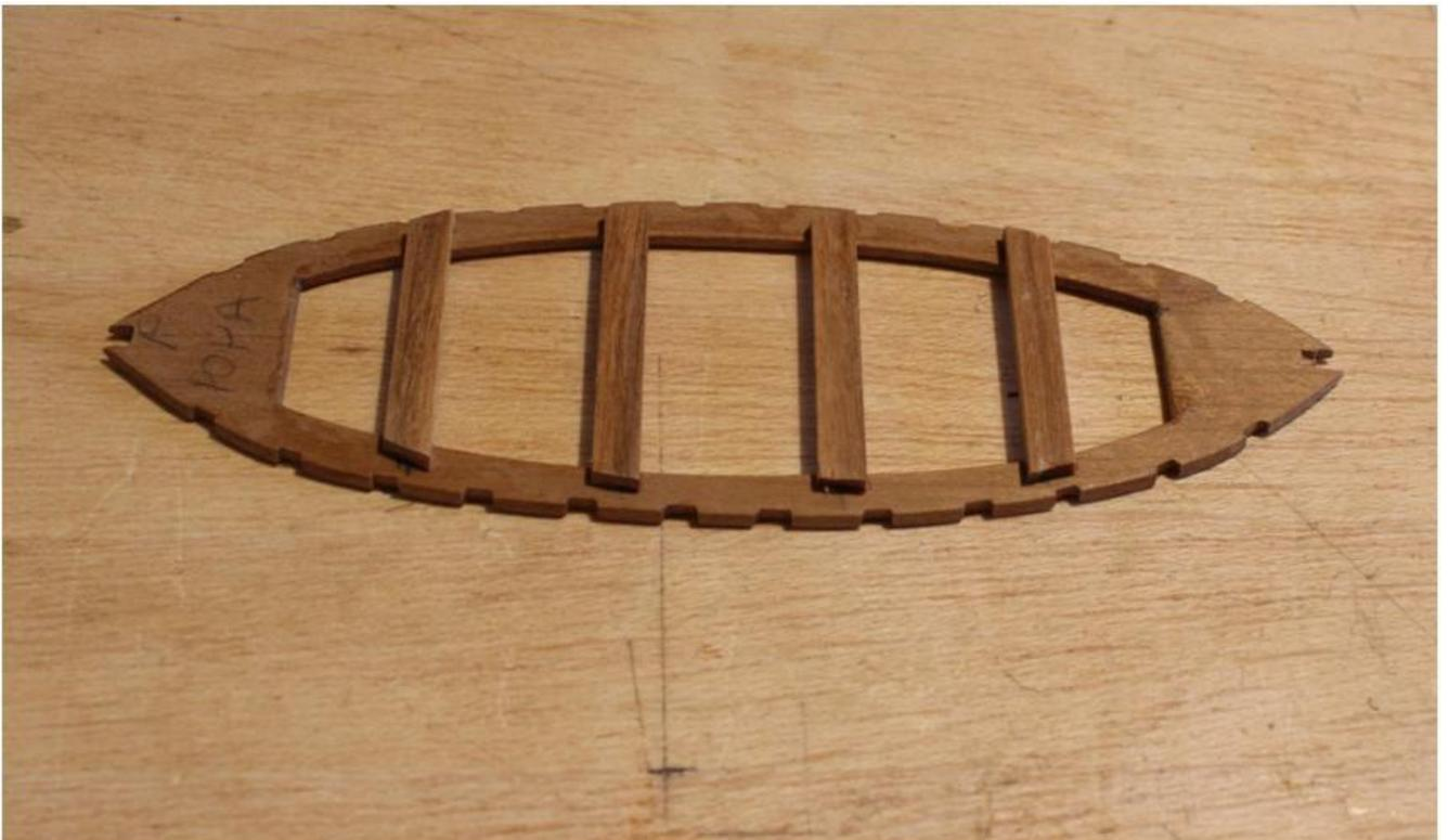
Coloco la estructura en el bote, añado unas cintas finas de cerezo en los costados y remato la borda con otra tira de cerezo. El bote está casi listo.
