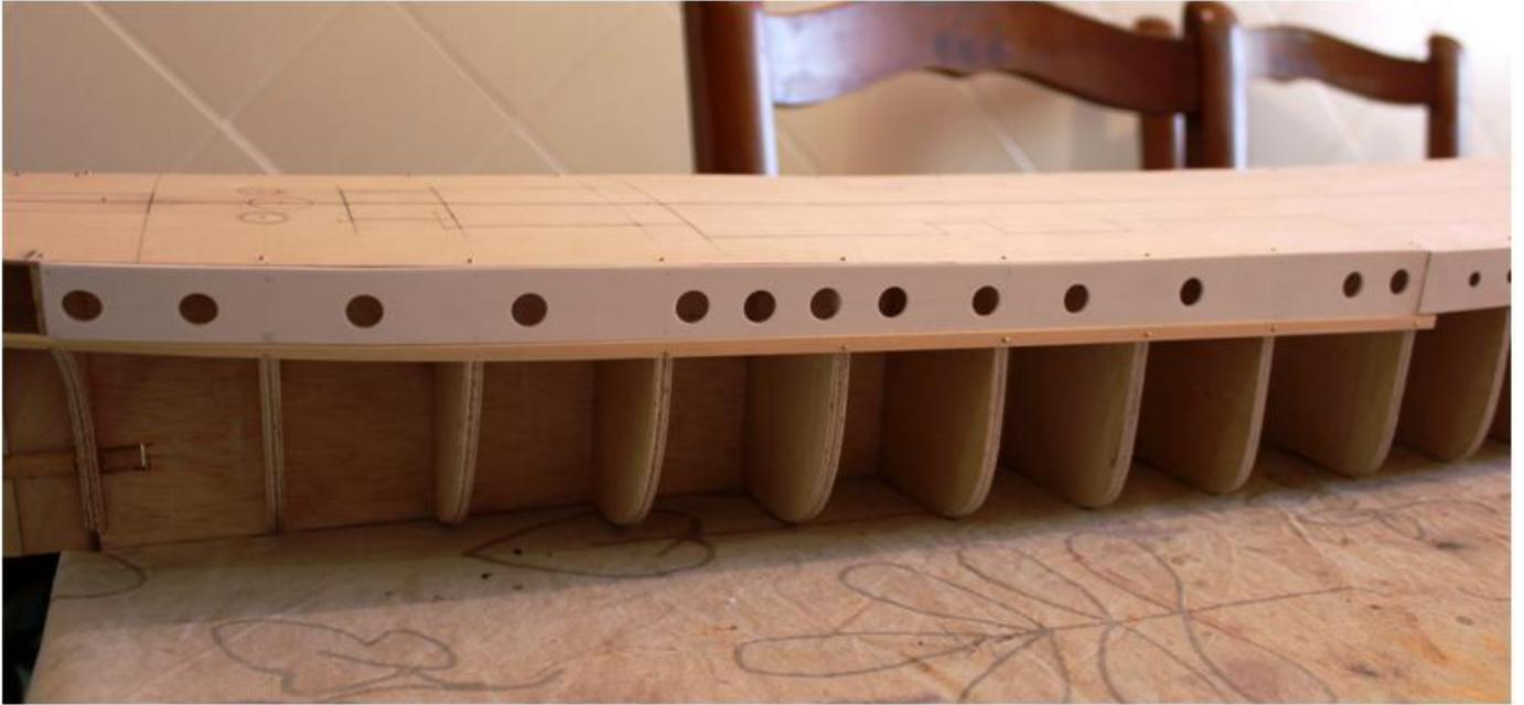
Para evitar que la pletina de aluminio se deforme en su parte superior voy a añadir al modelo los trozos de bordas de las amuras. Las piezas las elaboro con plancha de poliestireno de 1,5mm de espesor. Para darles forma, doblo las mismas con la mano.
