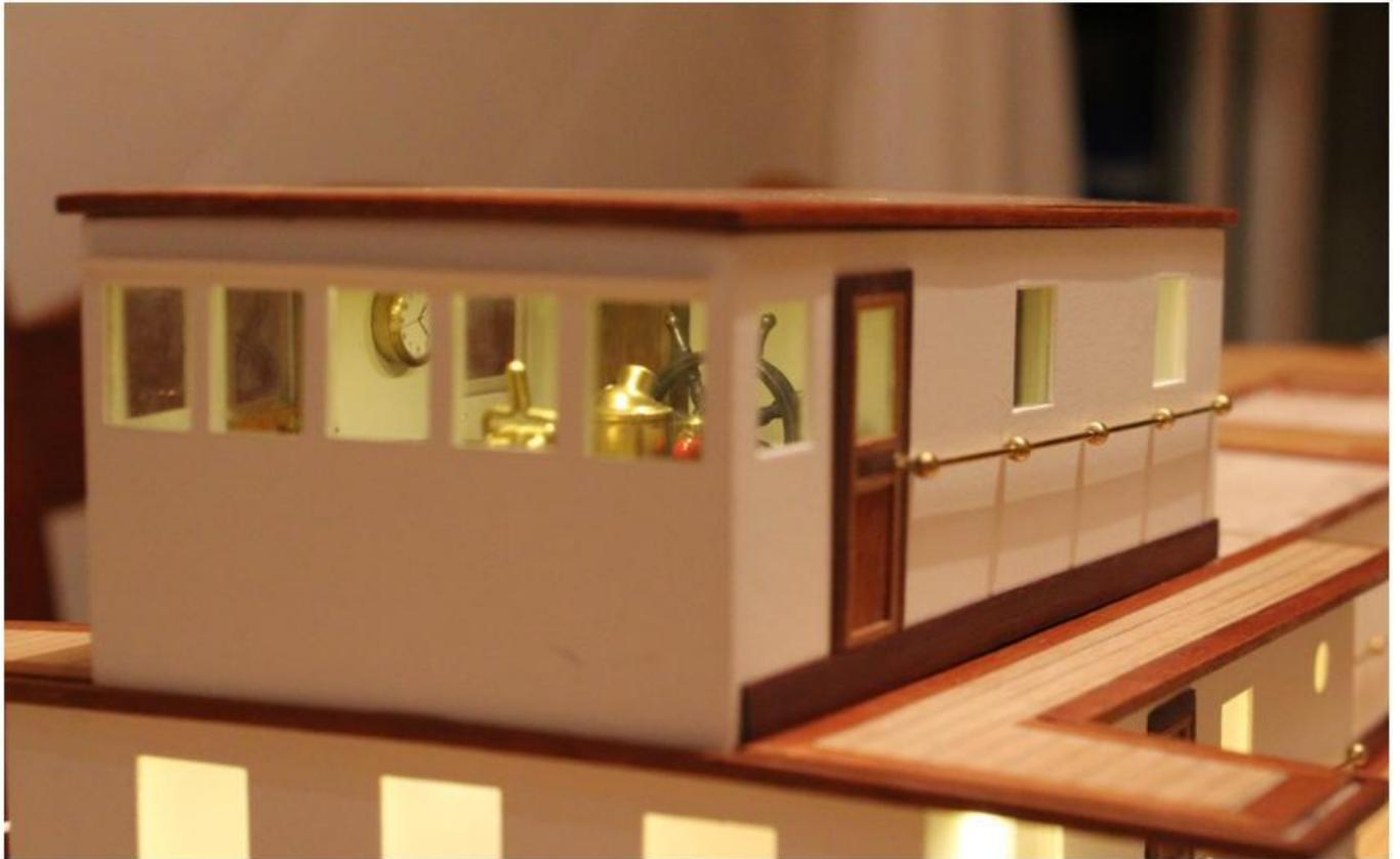
Para los cristales he utilizado una plancha de plástico rígido de 1,5 mm de espesor que adquirí en su día en Model Reyna y que utilicé en "La Palma". La verdad es que este material va de maravilla ya que al ser rígido los cristales quedan perfectamente planos, sin ondulaciones. Aún me queda más de media plancha para futuros modelos...
