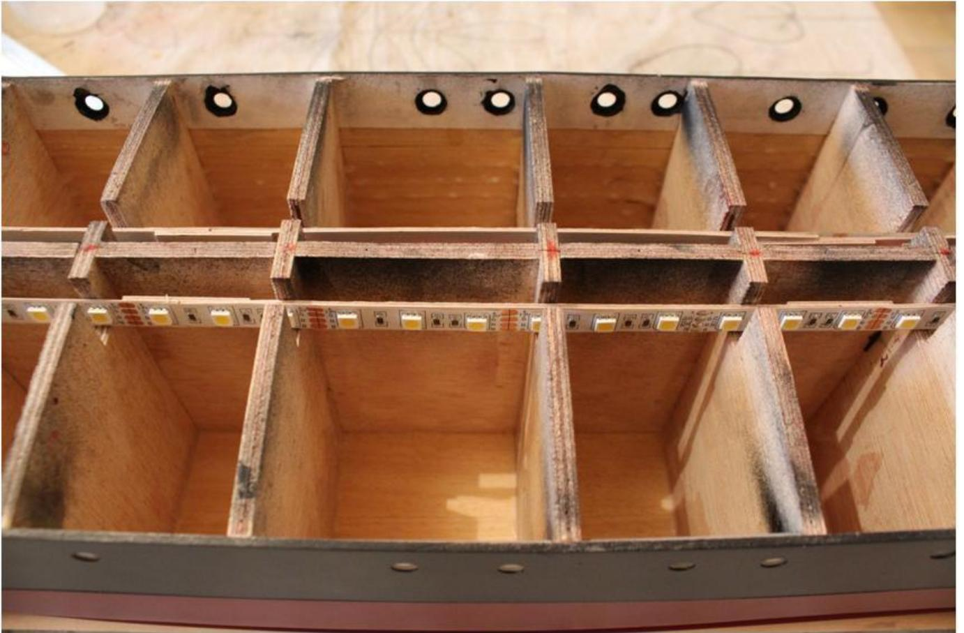
Preparo el cableado que debe alimentar los leds que irán sobre los elementos de la cubierta. El cable que alimenta la instalación del modelo lo saco por la parte inferior del casco, a la altura de la peana.
