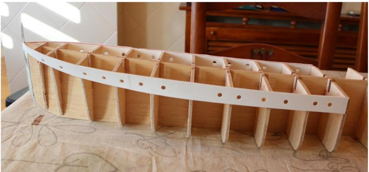
En la siguiente foto se muestra la plancha base de la zona de popa ya pegada a la estructura y el listón de ayus que sirve de apoyo para la plancha exterior.
