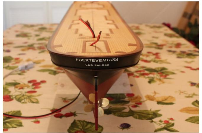
La pala del timón la fabrico con un trozo de contrachapado de abedúl de 3mm de espesor. Lijo bien la parte posterior de la pala para que quede afilada y le añado algunas tiras finas de poliestireno para simular los herrajes.
