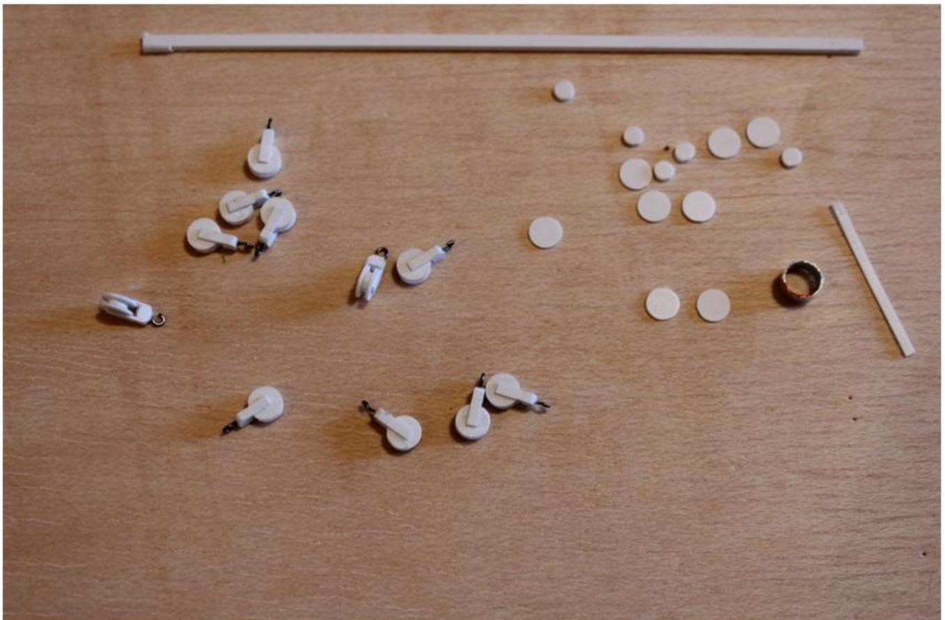
Los motones y cuadernales los fabrico también con cinta de poliestireno de 3 mm de ancho, discos de 2 mm de diámetro y alambre de acero de 0,5 mm.
