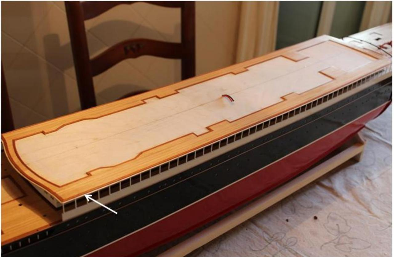
Lo siguiente ha sido construir la estructura del contorno de la cubierta. He decidido construir los ventanales de la parte frontal de una sola pieza para evitar defectos que se pudieran derivar por falta de alineación. Esta estructura hay que planificarla muy bien para que ajusten perfectamente las demás cubiertas que colocaremos más adelante.
