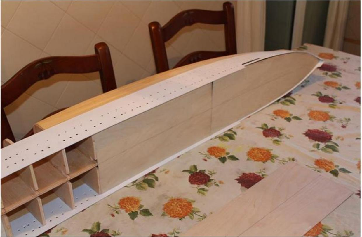
Una vez terminado de forrar el casco llega la hora de lijar y enmasillar. Posteriormente se pinta con pintura convencional y se lija al agua.
