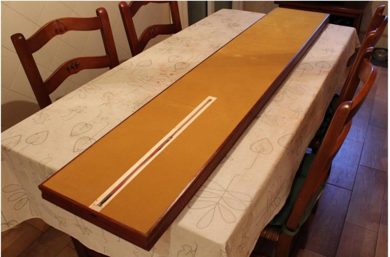
El trozo de fieltro que he recortado lo guardo para pegarlo cuando empalme los clavos. También he reservado el trozo de contrachapado que saque al hacer la ranura. Lo rebajo con la sierra circular conforme al espesor de los cables.
