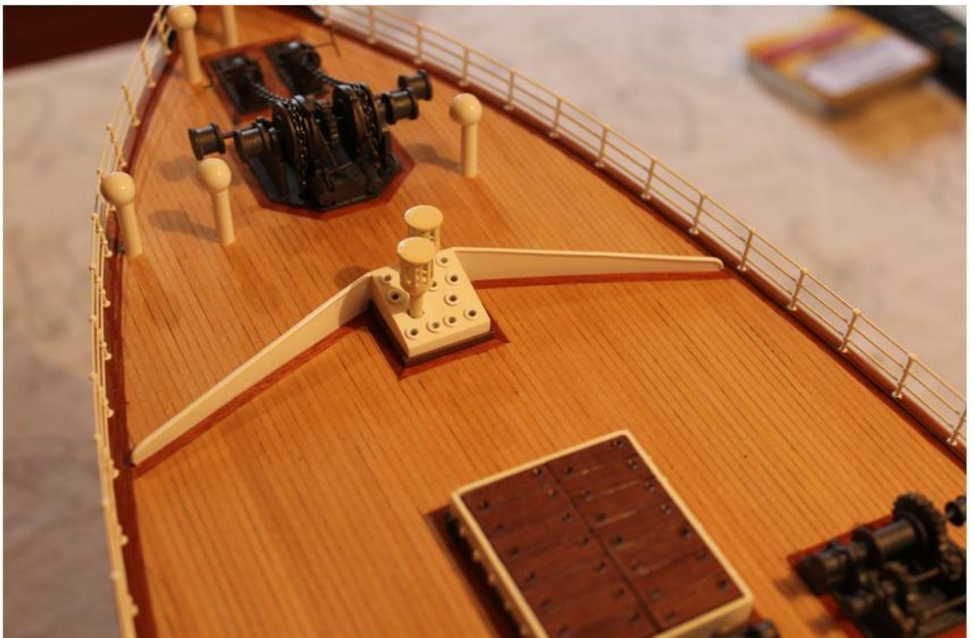
Para fabricar las bases de la bitas corto trozos de planchas de poliestireno de dos grosores diferentes (1 y 0,5mm). Los vástagos los elaboro con aluminio de 4mm de diámetro y la parte superior con círculos de poliestireno.
