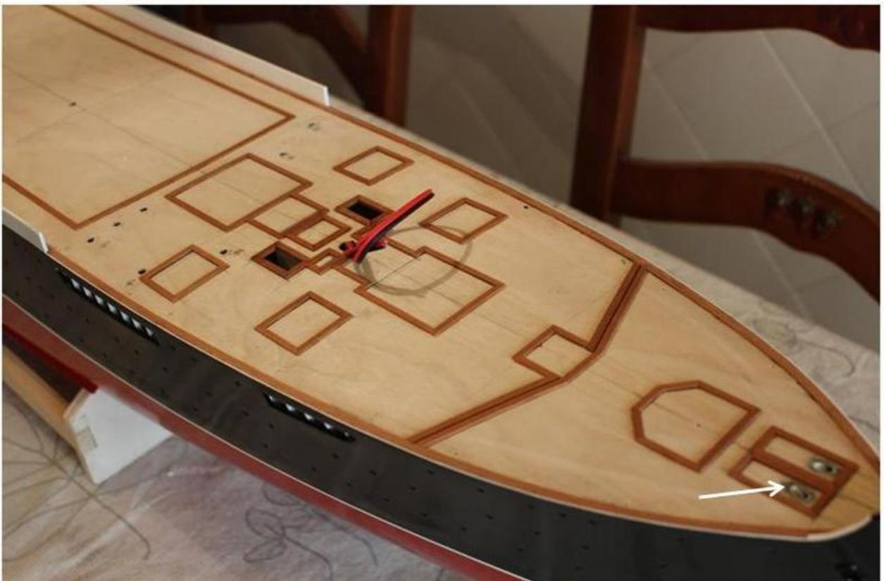
He insertado un tubo de aluminio de 5mm de diámetro para unir los orificios por donde pasan las cadenas con los escobenes para facilitar la colocación de las anclas y para evitar que se filtre la luz por los mencionados orificios.
