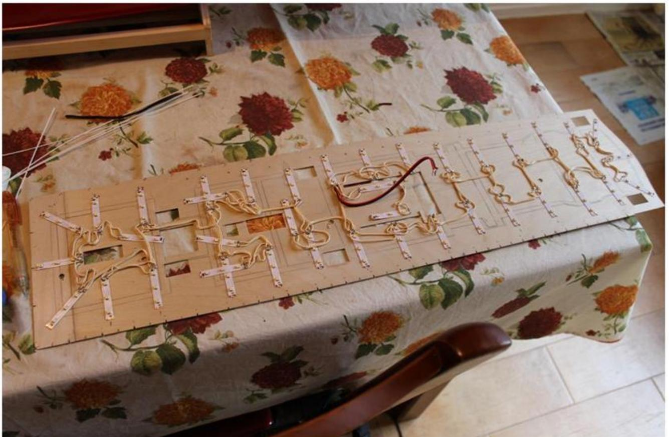
En la parte superior de la estructura practico unos rebajes en aquellos lugares por donde pasan las tiras de leds. Igualmente rebajo los mamparos transversales por donde deben pasar los cables.
