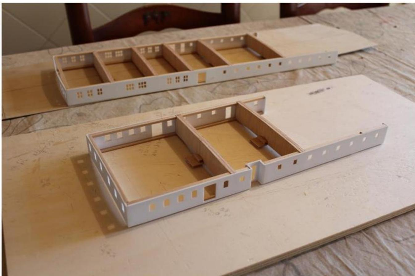
Se imprimen las piezas y se pintan. Añado las puertas, pasamanos, zócalos y los cristales de forma similar a como hice en la cubierta superior. Se fija la estructura en el modelo.
