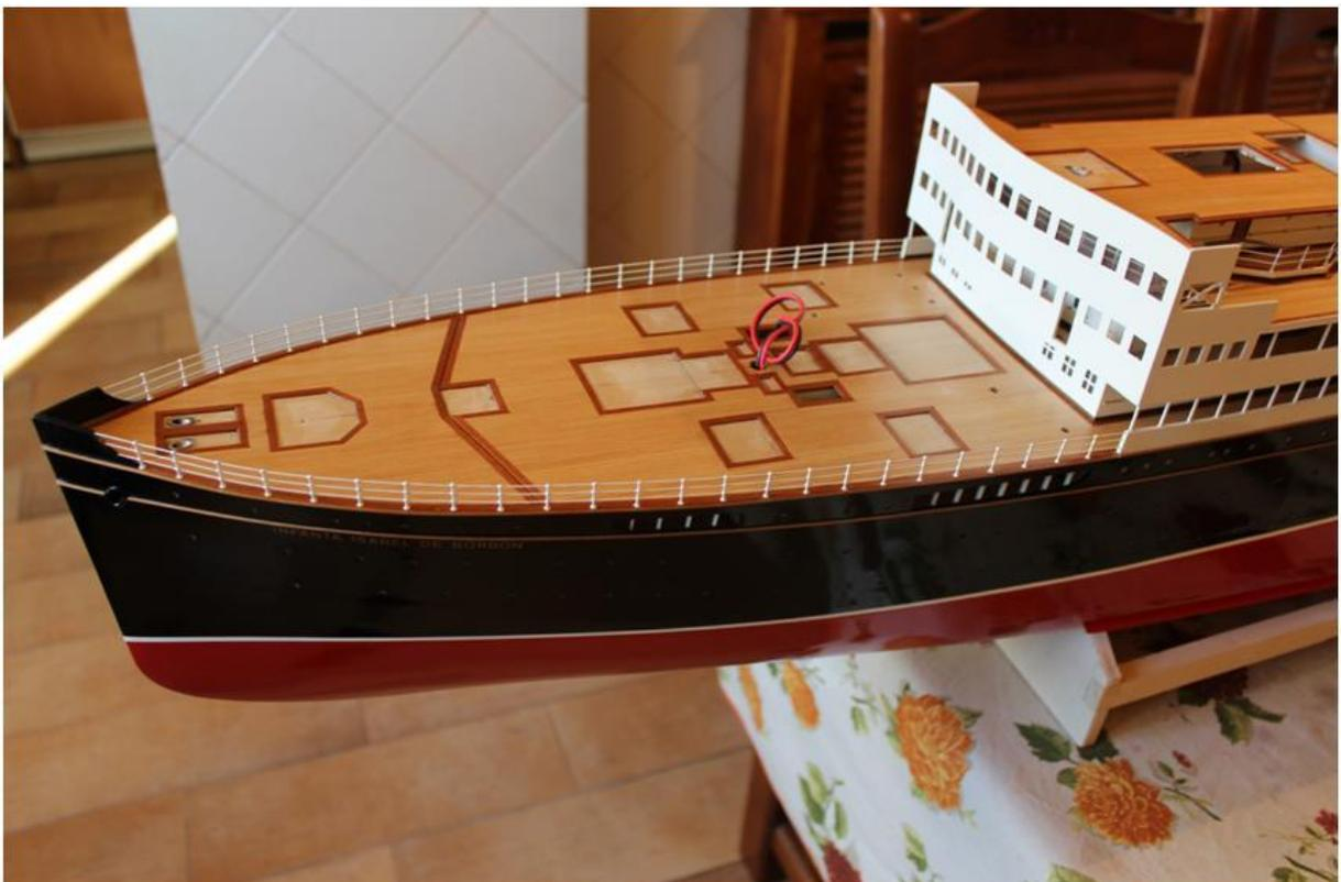
Fabrico la estructura del salón de 3ª clase y de la sala donde se aloja el sistema de dirección del barco. Sobre esta estructura va ubicada lo que sería la prolongación de la cubierta de paseo de la zona de popa.
