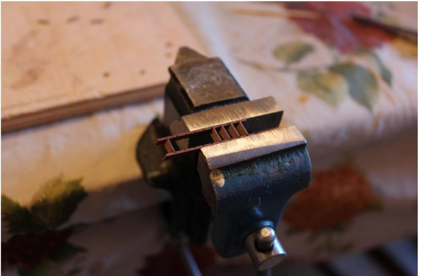
En la base de la escalera practico un orificio de 0,5mm de diámetro. Posteriormente de una plancha de manzonía de 1,5mm de espesor saco unos filetes para elaborar los pasamanos y con alambre de acero de 0,5mm de diámetro fabrico la barandilla.
