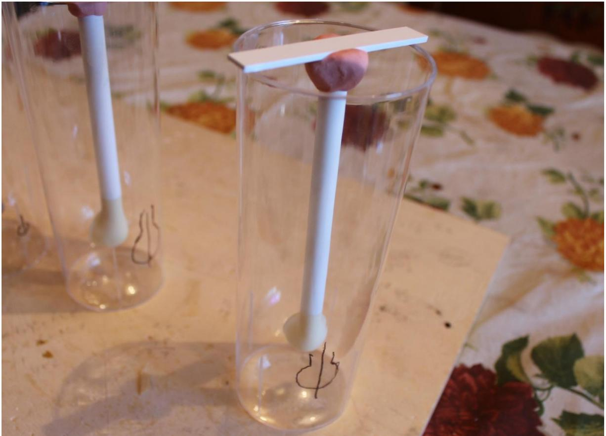
Añado la silicona y coloco un objeto pesado en la parte superior del molde para evitar que el conjunto se mueva.
