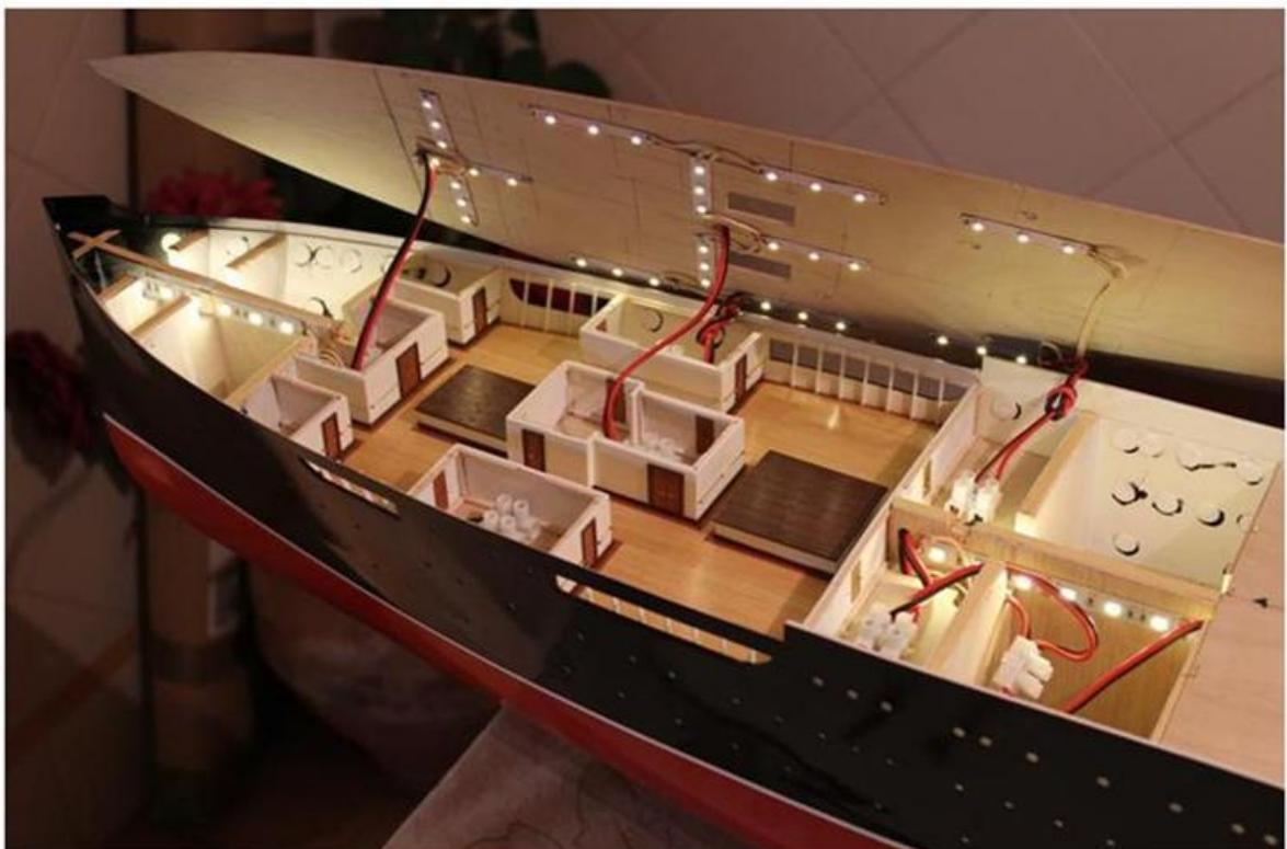
Terminada esta fase y comprobado el buen funcionamiento de la instalación eléctrica se procede a fijar la cubierta de sombra en el modelo. En esta cubierta he dibujado todos los elementos que irán sobre la misma y he practicado huecos y orificios donde hay lumbreras o por donde deben pasar manguerotes y escaleras.
