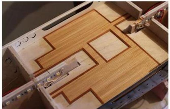
Antes de colocar los trozos de cubierta en el modelo hay que ampliar la instalación eléctrica y llevar cables a las zonas que deben ir iluminadas.
