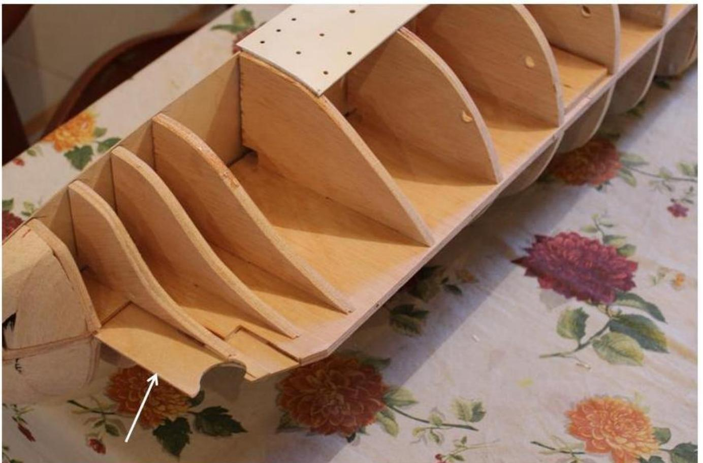
En popa he colocado unos tacos de madera de balsa que he lijado conforme a la forma de la cubierta y de la estructura del casco.
