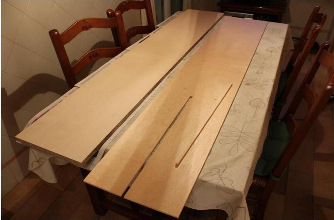
Clavo los dos tableros y añado unos perfiles de samba para crear el hueco donde se alojará la urna de metacrilato. La estructura la barnizo con barniz-tinte de color caoba. Lijo con lija muy fina y encero para obtener una acabado tipo 'antiguo'.
