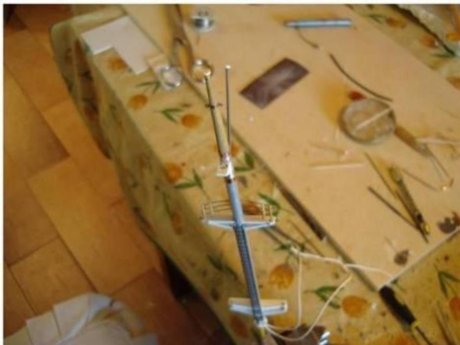
Construimos también los brazos de las grúas. Los hacemos con tubos concéntricos de aluminio. En la base practicamos una ranura e insertamos un cáncamo a cada brazo. Fijamos el cáncamo al tubo con un clavo. Estos cáncamos se introducirán en los tubos de las estructuras inferiores de los palos. De esta forma los brazos podrán girar horizontal y verticalmente.
