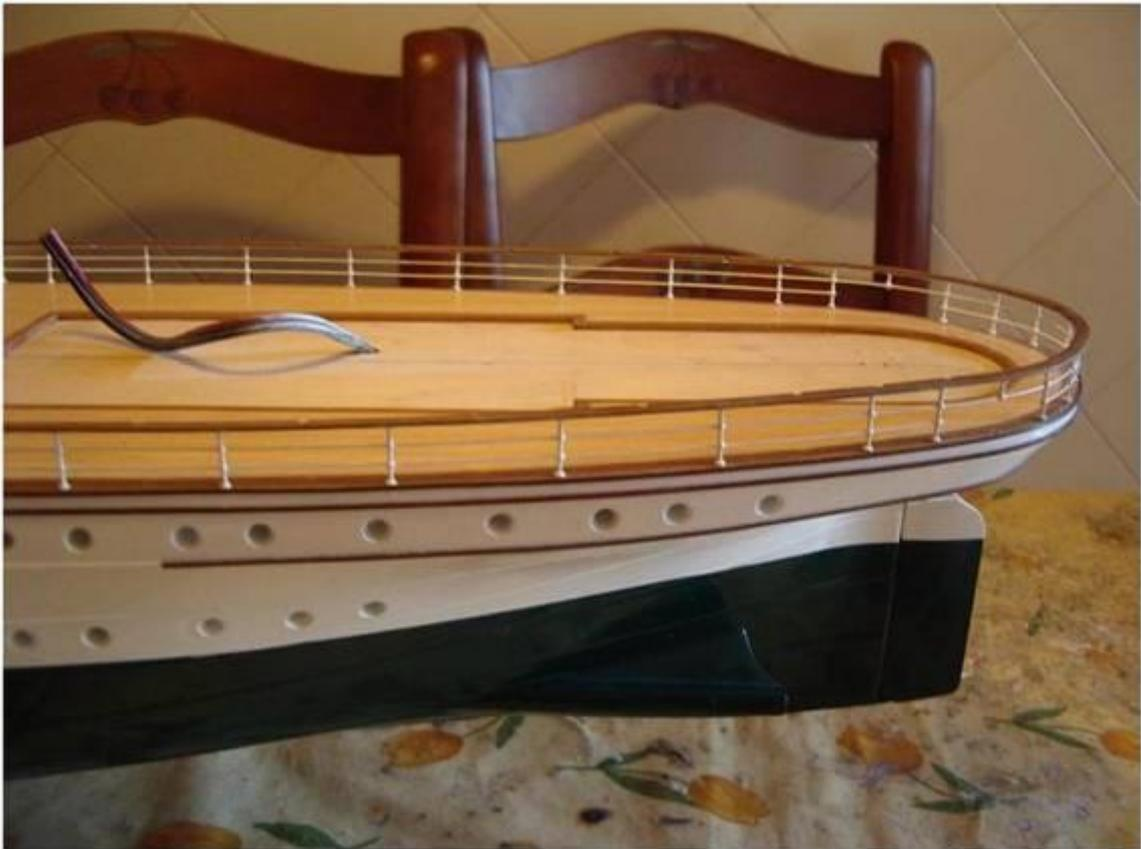
Pintamos la estructura sobre la que apoya la toldilla y colocamos los cristales, planchas de contrachapado, zócalo, etc.
