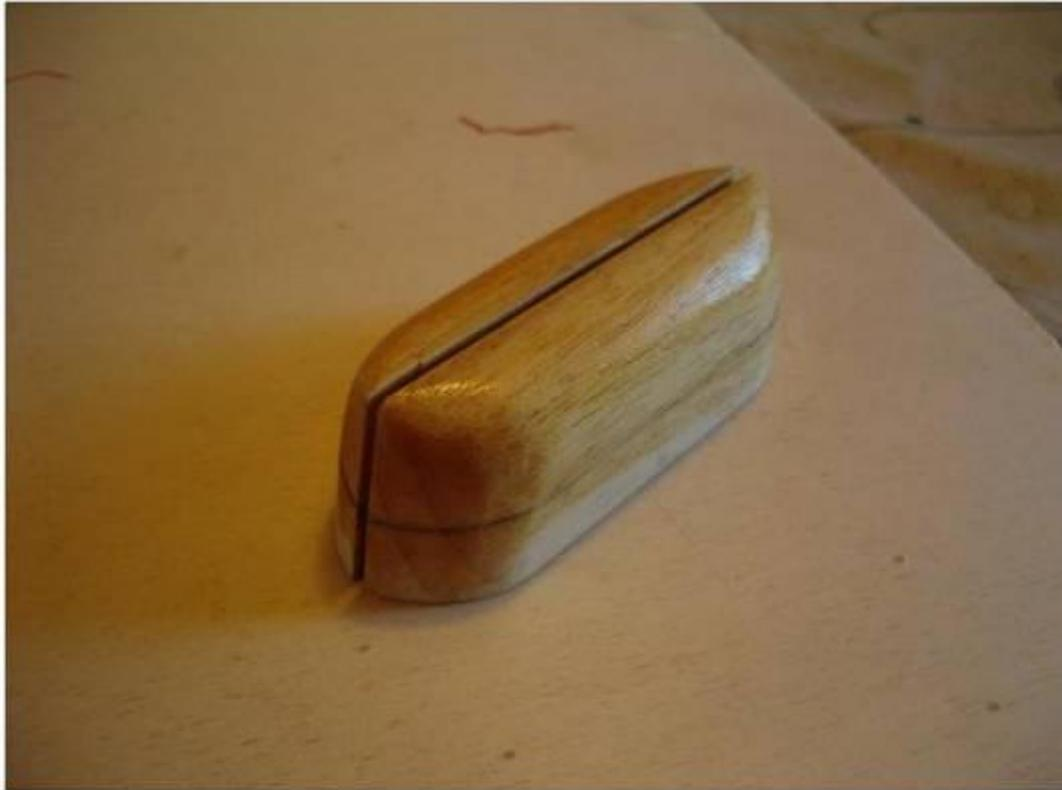
De una plancha de manzonía sacamos la estructura y las tracas. En el molde montamos las piezas con cuidado. Para que las maderas no se peguen al mismo barnizamos el molde ligeramente.
