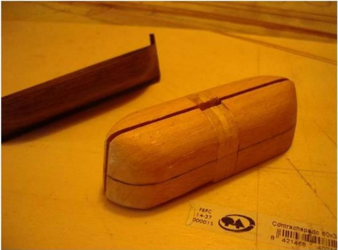
Una vez lijado y barnizado el casco he construido la estructura superior del bote. Está hecha de cerezo y manzonía. En las siguientes fotos se muestra el proceso seguido.
