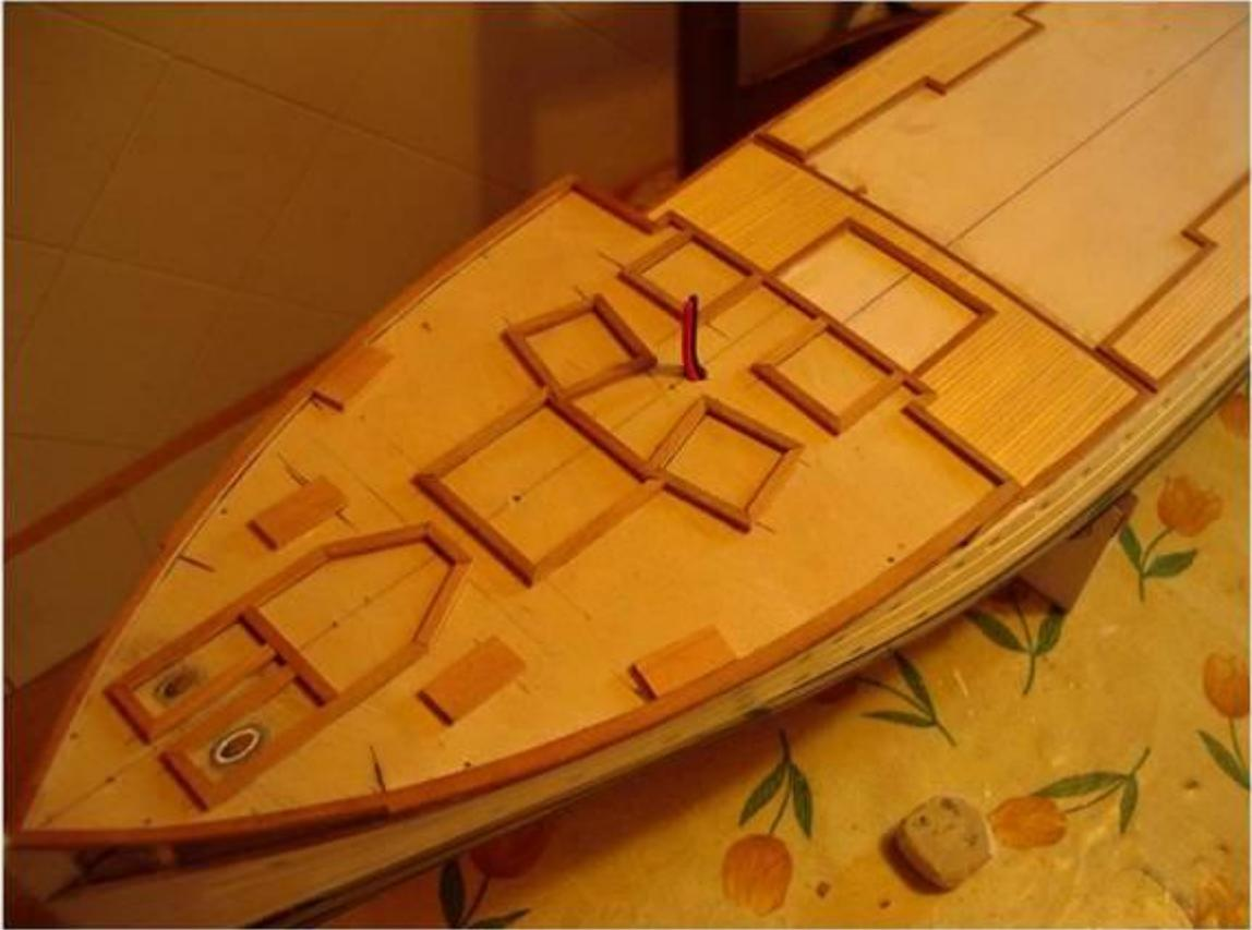
Para el paso de las cadenas y a fin de evitar que la luz salga por los orificios he colocado unos tubos de aluminio desde la cubierta hasta los escobenes. Una vez terminada la cubierta se colocan las piezas de las amuras y se enmasilla en las uniones para nivelarlas con las tracas.
