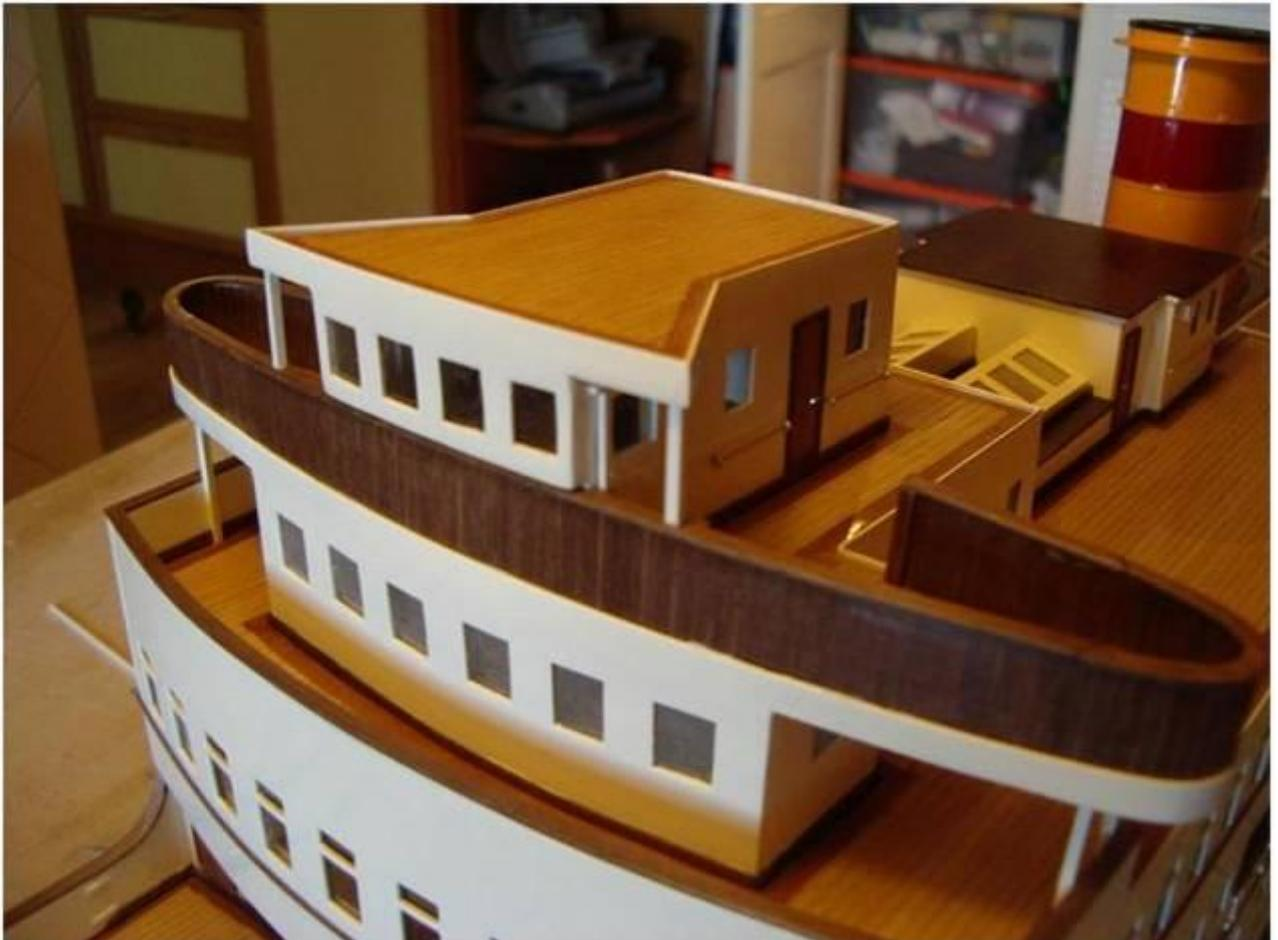
En la parte posterior de la cabina he colocado una escalera que accede a la cubierta superior. Esta fabricada con redondos de acero de 0,8 y 0,5 mm.
