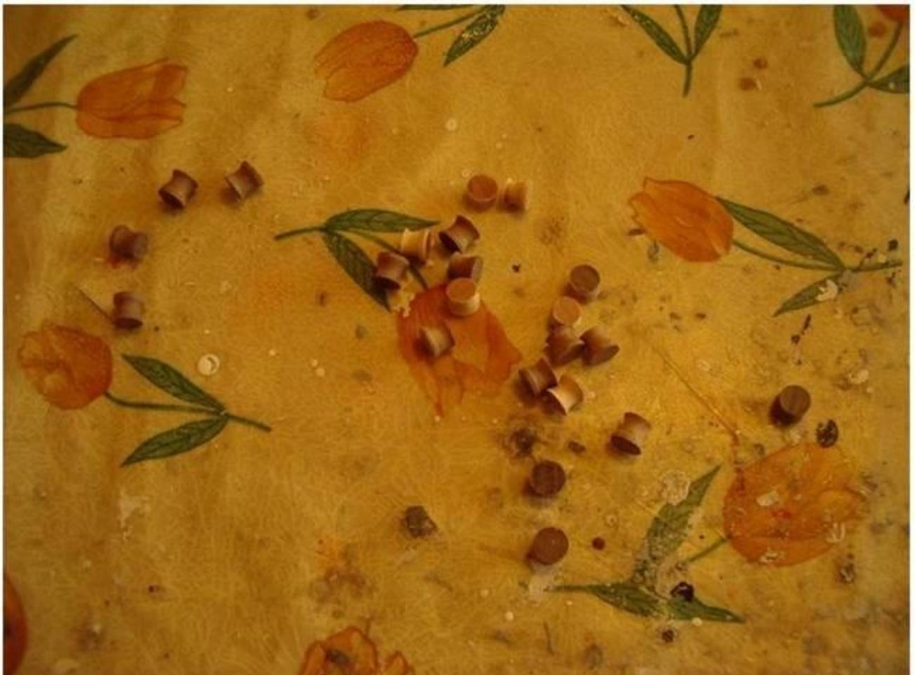
La construcción de los engranajes la realizamos con trozos de poliestieno que lijamos con ayuda de una arandela de forma similar a como expliqué para fabricar las hélices. Para elaborar los dientes basta con marcar el canto del círculo con una lima triangular.
