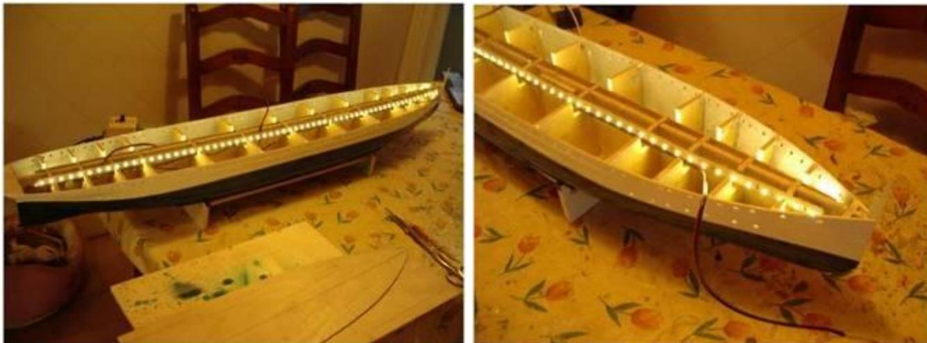
Una vez terminado la instalación eléctrica he fijado la cubierta principal. Está elaborada con una chapa de contrachapado de 1 mm en la que previamente he dibujado donde se ubicarán los diferentes elementos.
