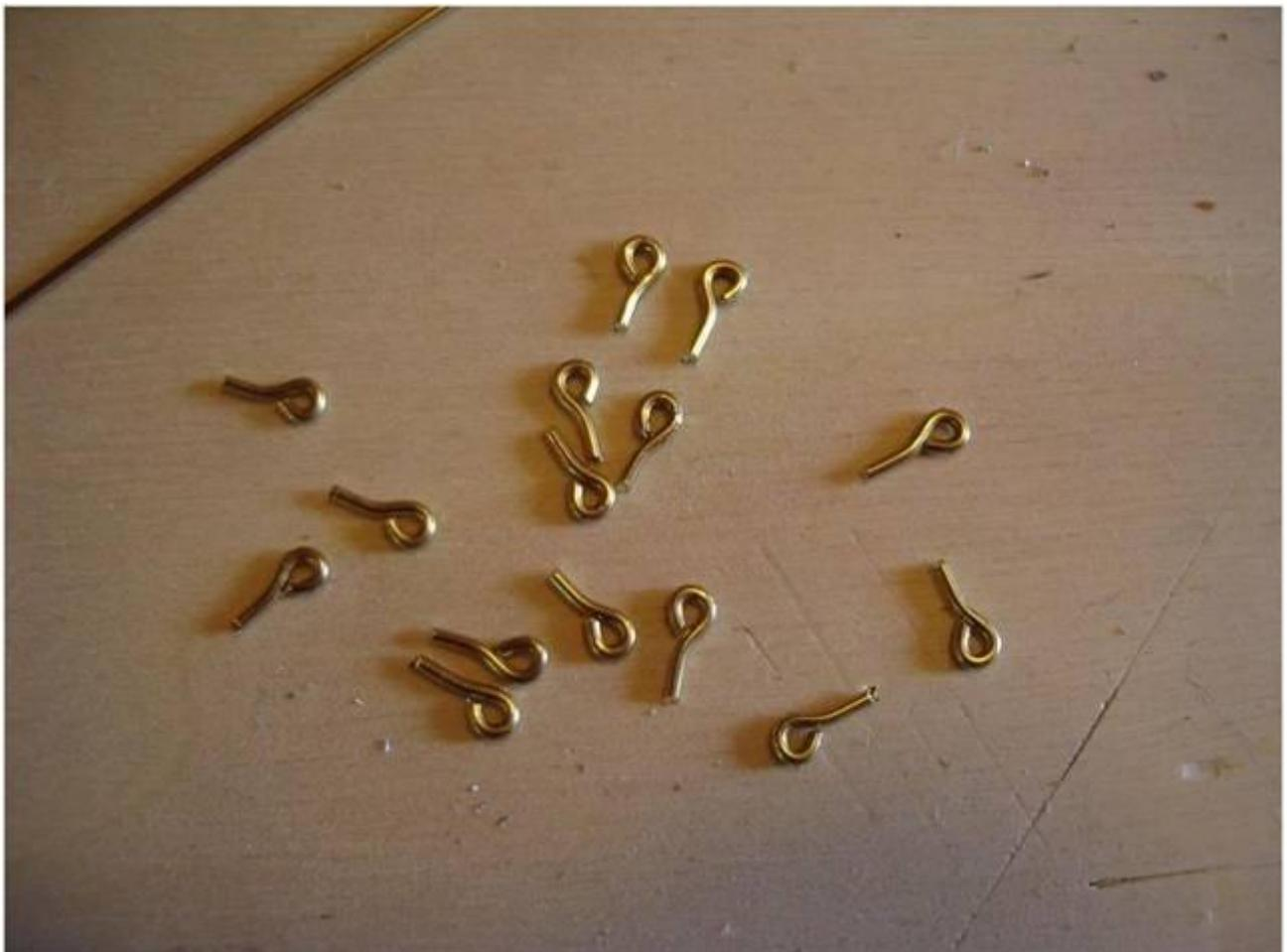
Fabricamos también unos cáncamos a partir de un redondo de acero de 0,5 mm que insertaremos en uno de los extremos a fin de fijar los tensores al modelo
