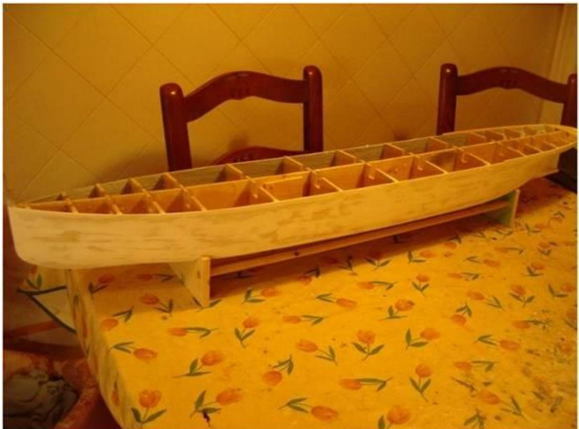
Como hice en mi anterior proyecto a este modelo le instalaré también un sistema de iluminación. Con el objeto que la luz no se filtre por las juntas es importante enmasillar bien el interior del casco. He utilizado putty que me dio buenos resultados en el Tynwald. Para facilitar la labor he retirado los travesaños que coloqué entre las cuadernas.
