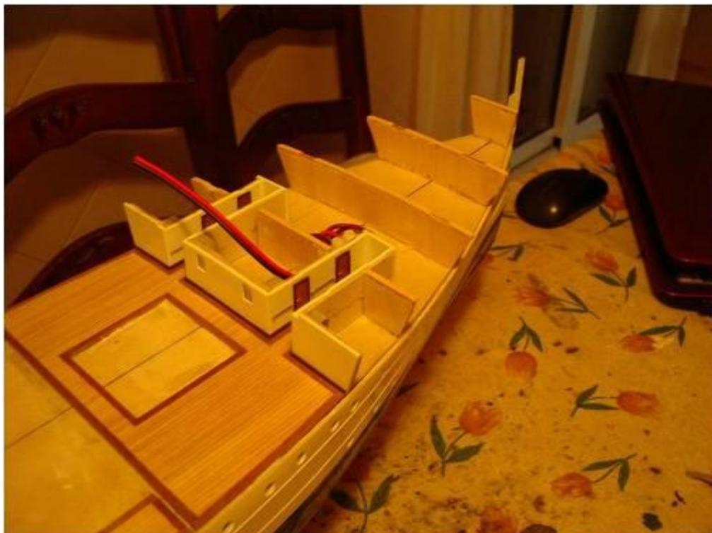
Antes de poner la cubierta del castillo hay que diseñar y colocar la iluminación. Para ello cortamos tiras de leds y las pegamos en el reverso de la plancha de contrachapado que servirá para construir la cubierta. Hay que planificar bien la ubicación de las tiras y rebajar ligeramente los mamparos por donde crucen las tiras y cables. Soldamos y unimos en paralelo.
