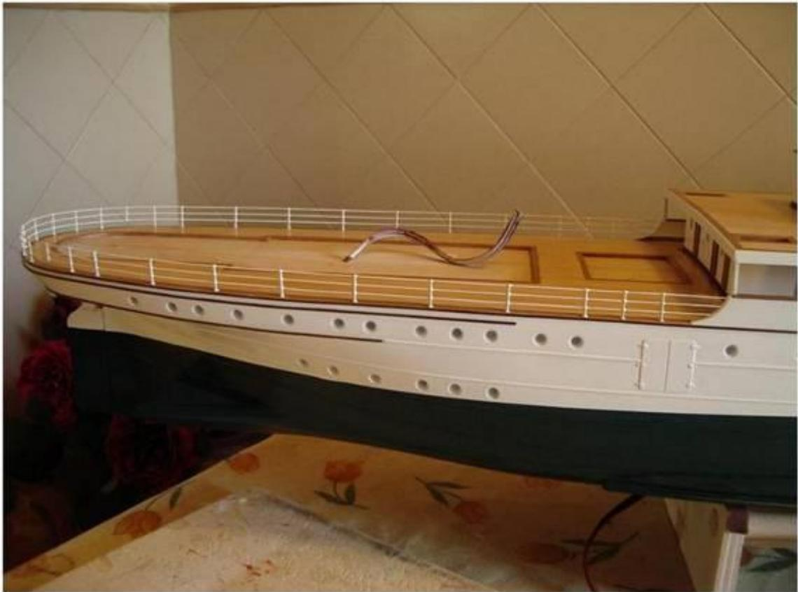
En la parte superior de las barandillas hay que ubicar el pasamanos de madera. Lo elaboramos con manzonía de 1mm de espesor y lo curvamos con la plancha, mojándolo primero. En la parte inferior marcamos con una broca de 2mm los puntos donde apoyarán las cabezas de los candeleros. Igualmente practicamos unas hendiduras por donde pasarán las columnas a las que me he referido anteriormente.
