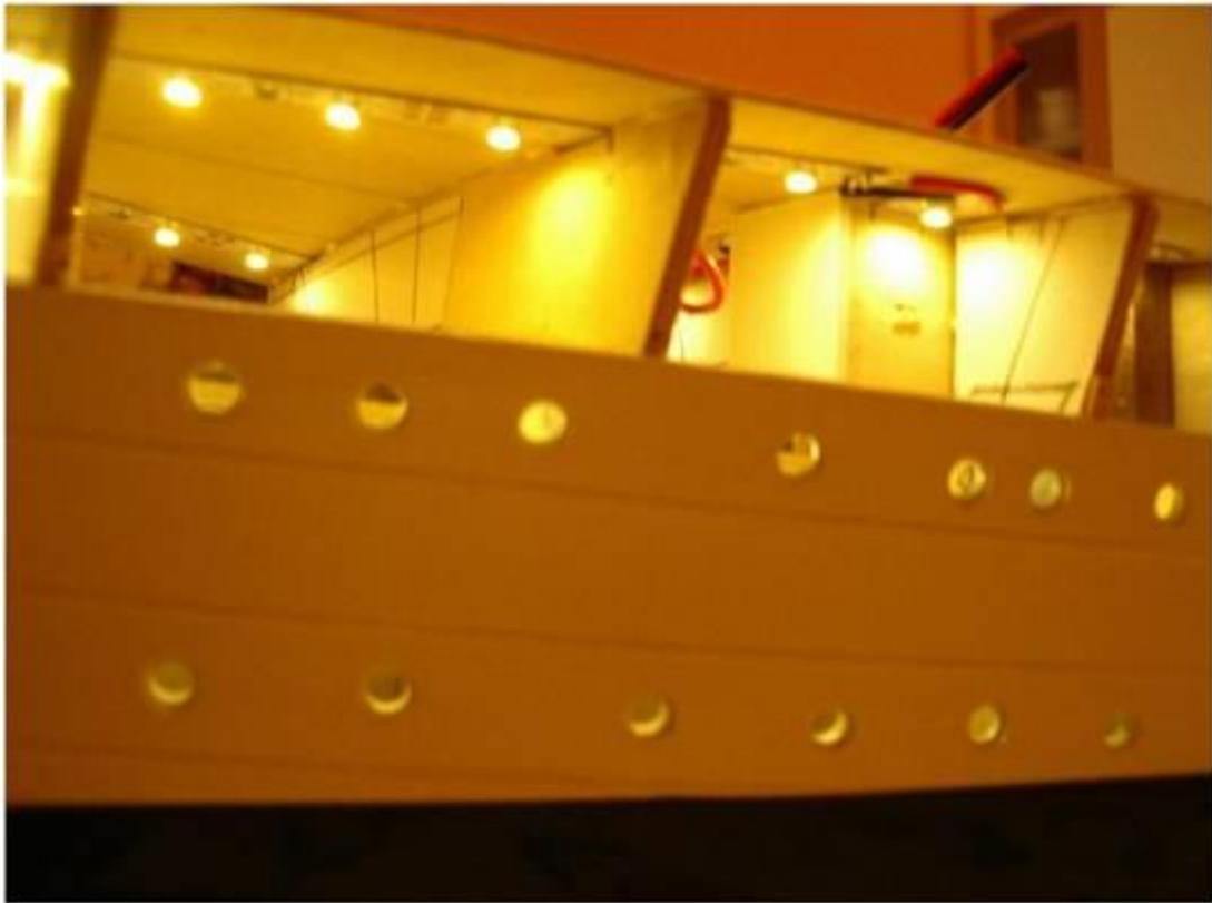
Lo siguiente es hacer las piezas que cierran el castillo por la amura. Para ello utilizamos plancha de poliestireno y las fabricamos conforme a las formas de los planos. Estas piezas una vez montadas deben quedar al ras con las tracas. El espesor de la plancha es de 1,5 mm, que es el mismo espesor aproximadamente al que han quedado las tracas una vez lijadas y pintadas.
