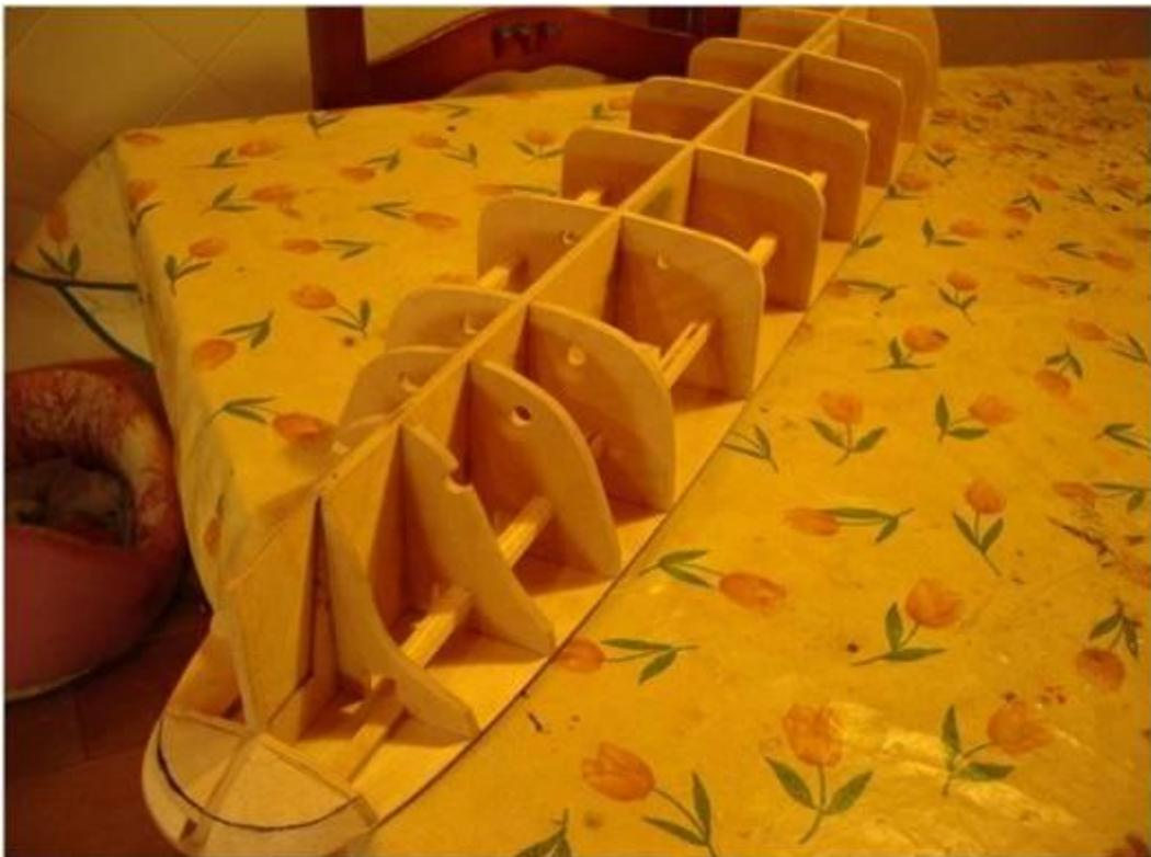
Antes de colocar las tracas y a fin de garantizar un mejor alineado del armazón clavamos una madera en la parte inferior de la estructura transversal. Igualmente clavamos temporalmente la cubierta principal y pegamos unas maderas entre las cuadernas. Estas las retiraremos una vez terminado el entramado a fin de poder maniobrar mejor en el interior del casco.
