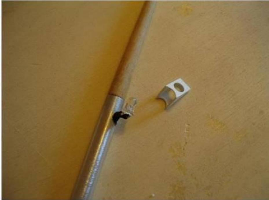
Para la estructura que sujeta las grúas y dado que no tengo información he diseñado y elaborado una estructura similar a la que veo en las fotos. En los extremos he colocado unos tubos de aluminio donde se apoyarán los brazos. Fabricamos y colocamos también unos cáncamos en los tubos para más adelante ubicar las poleas.
