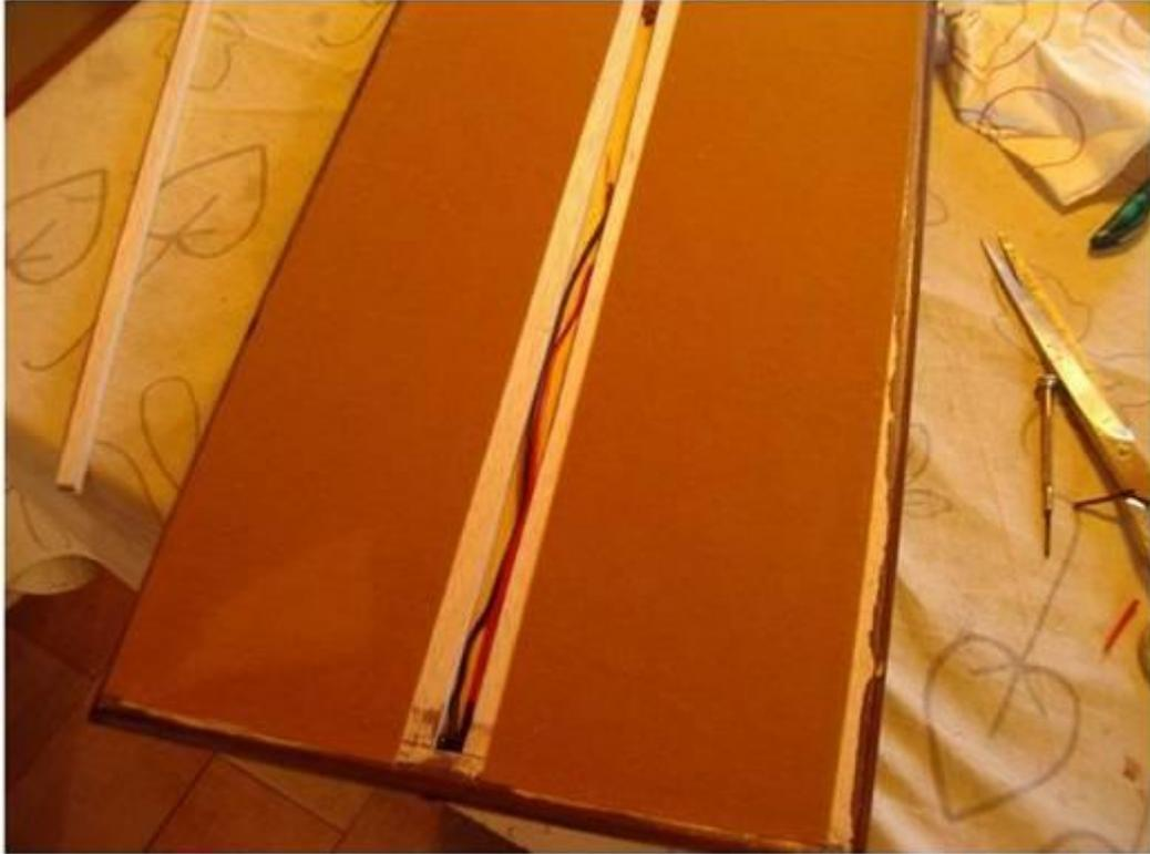
De un tablero de manzonía de 8 mm de espesor cortamos las piezas donde se apoyará el barco. A la pieza de popa le practicamos un orificio por donde deberá pasar el cable.
