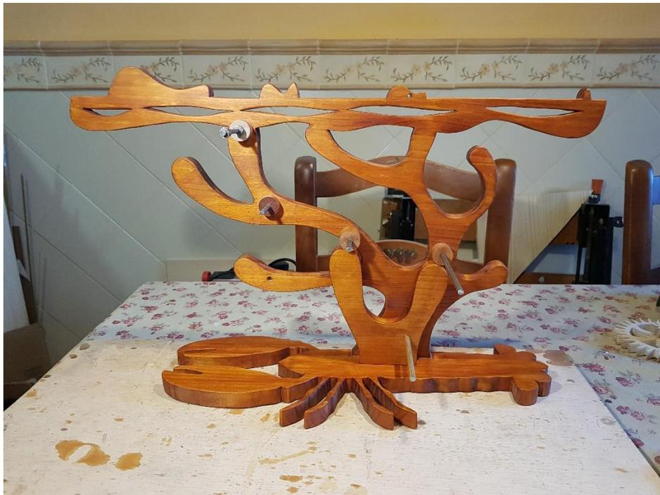
Otra cuestión que he modificado durante la construcción respecto del diseño original ha sido la “profundidad” del reloj. En el diseño dispuse de arandelas y soportes de grosores relativamente “generosos”. Durante la construcción he tenido que limitar estos grosores al mínimo imprescindible, a fin de reducir los pares de fuerza a los que está sometida la estructura, tal como he referido anteriormente.
